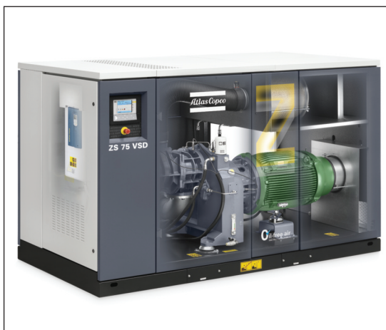
ZS: soffianti volumetriche a vite oil-free, con portate da 300 a 10.000 mc/h e pressioni da 0,3 a 1,2 barg
